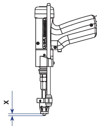
Bei einem eingestellten Überstand (Eintauchmaß) von 2 mm ergibt sich ein tatsächlicher Abhub von 4 mm, bei einem eingestellten Überstand (Eintauchmaß) von 4 mm ergibt sich ein tatsächlicher Abhub von 2 mm.
