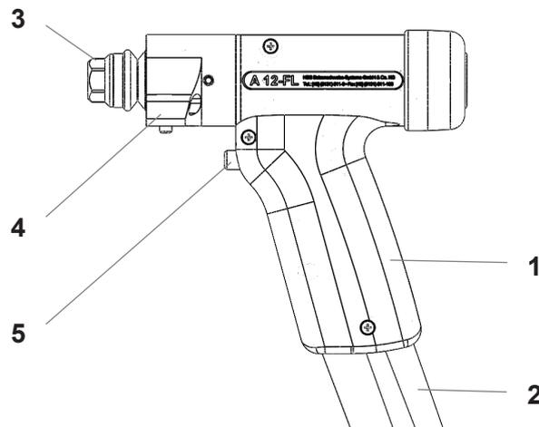
Die Bolzenschweißpistole A 12-FL ist mit einem feststehenden Abhub von 6 mm ausgestattet.
